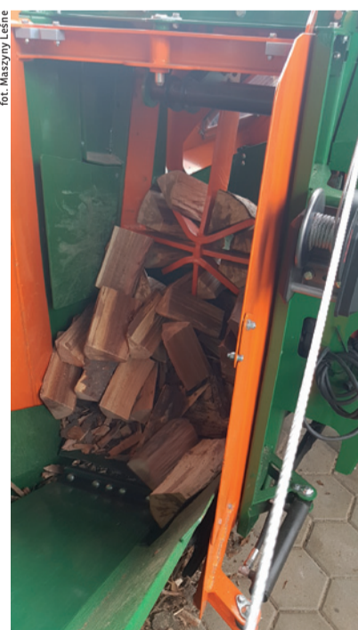
Nawet do ośmiu noży ramowych i pochylenie komory łupania, dzięki czemu poszczególne polana nie ulegają zakleszczeniu, znacznie skraca czas pracy.
